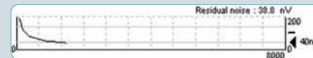
Anstatt Tests mit einer bestimmten Anzahl von Stimuli durchzuführen, kann ein geringes Restrauschen (Residual noise) als Stoppkriterium genutzt werden.
